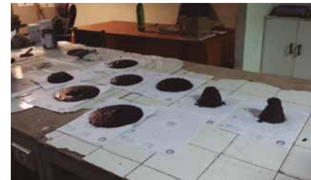
■ Método del cono para medir la consistencia de la lechada asfáltica
