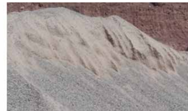
■ Banda granulométrica Tipo B1, polvo de roca acopiado y segregado
