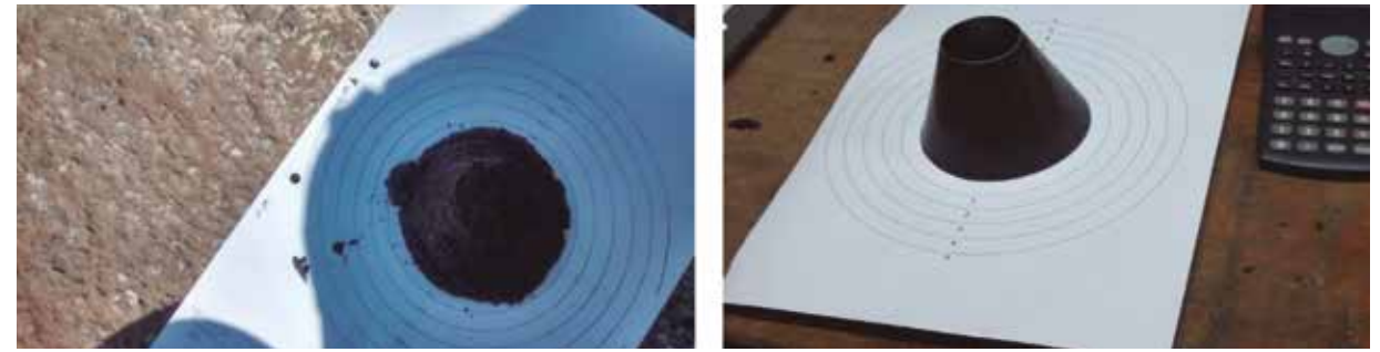
■ Ensayo del cono en terreno para Lechada Asfáltica
