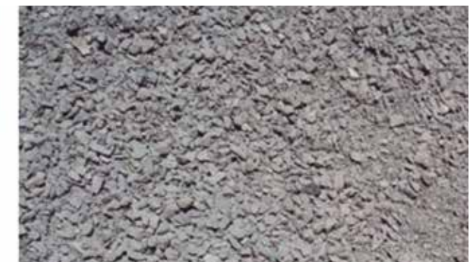
■ Banda granulométrica Tipo C1 - polvo de roca suministrado con mucha laja
